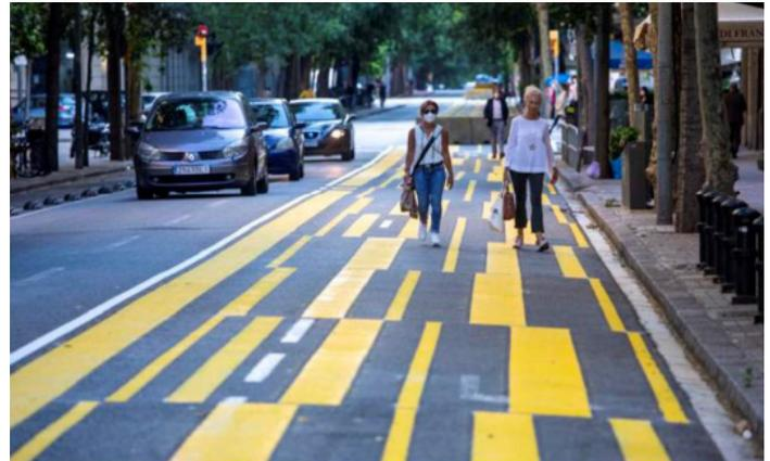
Intervención que aumenta el espacio peatonal, define los tramos de desplazamiento mediante pintura en la calzada y pone barreras móviles en las esquinas de la calle permitiendo dar una señal clara en los bordes de cada manzana.
